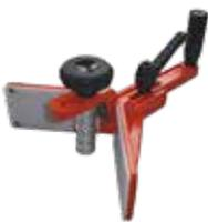
Handliches Rohranschrägerät zum Anfasen der Rohrenden im Handumdrehen.
