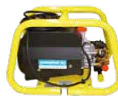
**Hochdruckpumpe für die Druckprüfung mit Wasser**
