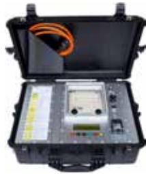
Hochgenaue und vollautomatische Durchführung von Druckprüfungen nach fünf verschiedenen Verfahren.
