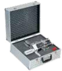
Gleichmässiges Schälen des Schweissbereiches von Kunststoffrohren als Vorbereitung zur Heizwendelschweissung.
