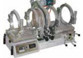
Werkstattmaschine zum Verschweissen von Rohren und Formstücken aus PE, PP und PVDF, ideal für Segment-schweissungen.
