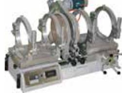
Werkstattmaschine zum Verschweissen von Rohren und Formstücken aus PE, PP und PVDF, ideal für Segment-schweissungen.
