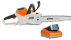
Handliche Kettensäge mit **Spezialkette für Kunststoffrohre** ausgestattet. Lässt sich mit Speiseöl (z. B. Rapsöl) betreiben und ist daher unbedenklich zum Schneiden von Trinkwasserrohren.
