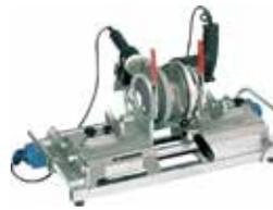
Zum Stumpfschweissen von dünnwandigen Rohren und Formstücken aus PE und PP, bis PN 4.
