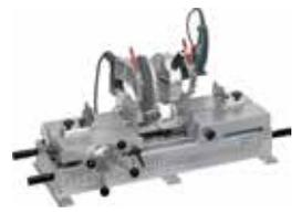
Zum Stumpfschweissen von Rohren und Formstücken aus PE und PP.
