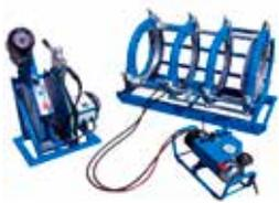
Universelle Stumpfschweissmaschine mit vielen Einsatzmöglichkeiten für Druck- und Abflussrohre.
