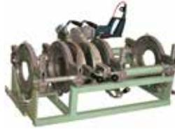
Universelle, kompakte Stumpfschweissmaschine mit vielen Einsatzmöglichkeiten für Druck- und Abflussrohre.
