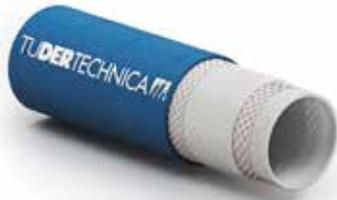
Hochwertiger und robuster Trinkwasserschlauch mit grosser Druckfestigkeit und ölbeständiger Aussenschicht. Geeignet für die Lebensmittel- und Getränkeindustrie, Grossküchen, Notwasserleitungen, Camping und zum Befüllen von Trinkwassertanks. Erfüllt die strengen Auflagen der Trinkwasserverordnung.
